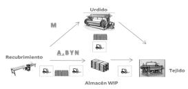
En esta figura se muestra el proceso de producción de la planta. Se puede observar el proceso que sigue el hilo. La primera etapa es el recubrimiento, de aquí puede pasar a almacenaje o a urdido para pasar finalmente al tejido. Fuente: Elaboración propia
